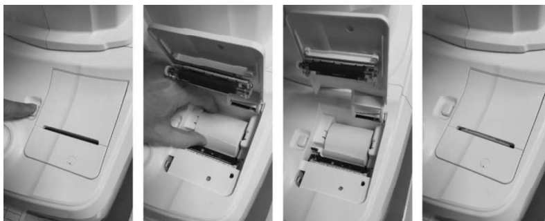
[Figura 9-3-1. Sostituzione della carta della stampante]
