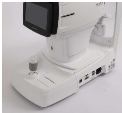
[Figura 6-1. Collegare il cavo di alimentazione]
