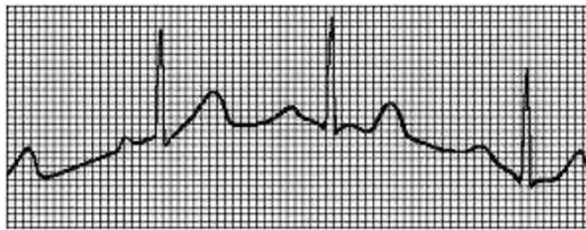
Figura 8.3 Schema della forma d'onda di deriva della linea di base
