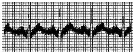
Figura 8.1 ECG in caso di interferenza CA.
